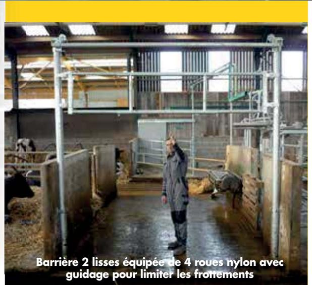
Barrière 2 lisses équipée de 4 roues nylon avec guidage pour limiter les frottements
