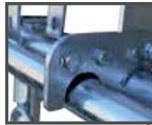
Fixations du double panneau au cornadis par boulonnage de supports techniques en partie haute, sur les supports de barres de commande soudés au cornadis. Ensemble fiable et robuste dans le temps.
