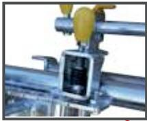
Poignée de commande à ressort permettant un indexage rapide à la position d'encolure du double panneau choisi.
