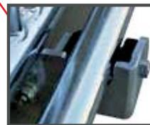
Fixations du double panneau au cornadis par boulonnage de supports techniques à galets centreurs sur des plats soudés en partie basse intégrés au cornadis. Ensemble fiable et robuste dans le temps.
